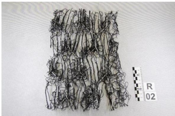
**C. Verbundstoff** aus einer PP-Geomatte und Stahlmaschendraht
