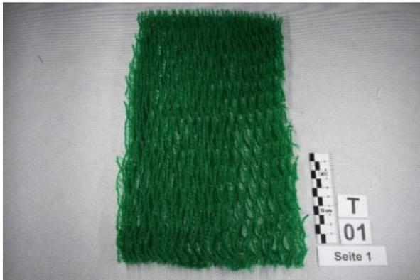
**A. Geozellähnliche Maschenware** aus PE-HD, wird bei Verlegung auf erforderliche Breite gezogen
