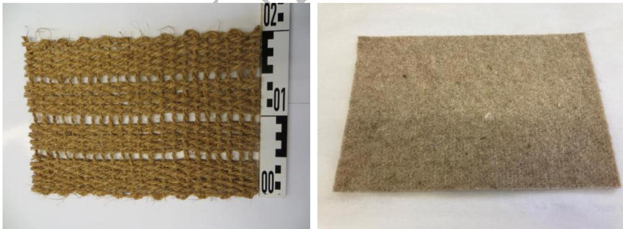
Bild 3.5 Böschungsband aus Kokosgewebe (Foto: R. Neisser); Böschungsband aus Schafwollvliesstoff (Foto: S. Wiese)
