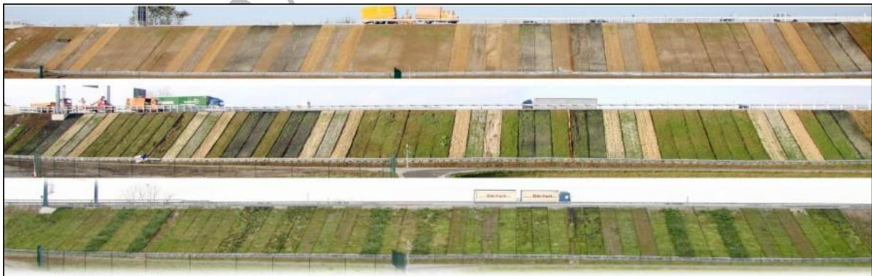
*Bild 1.1 Versuchspartellen mit verschiedenen Erosionsschutzprodukten und Begrünungshilfen aus synthetischen und natürlichen Materialien am Testfeld Biebelried BAB 3, Herbst 2009 (oben), Winter 2009 (Mitte), Frühjahr 2010 (unten) (Foto: SKZ-Testing GmbH)*
