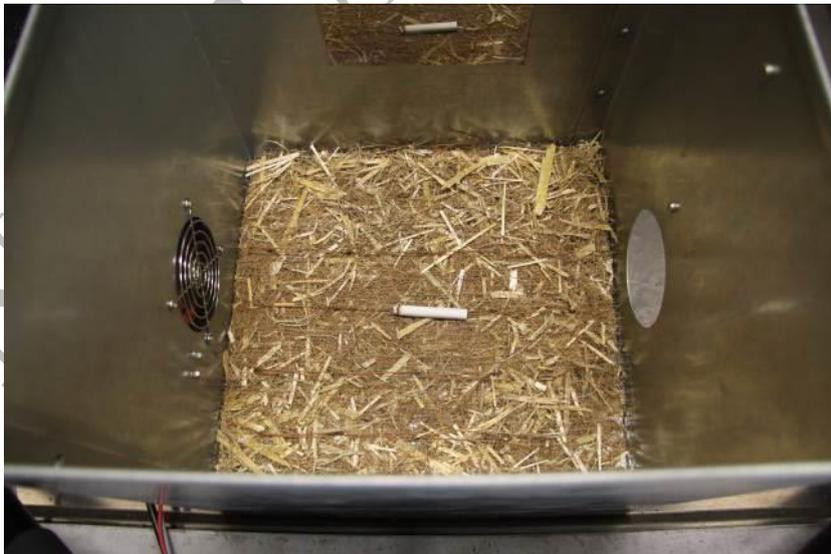
*Bild A10.5.1: Messeinrichtung zur Bestimmung der Schwelfestigkeit (Foto: SKZ – Testing GmbH)*
