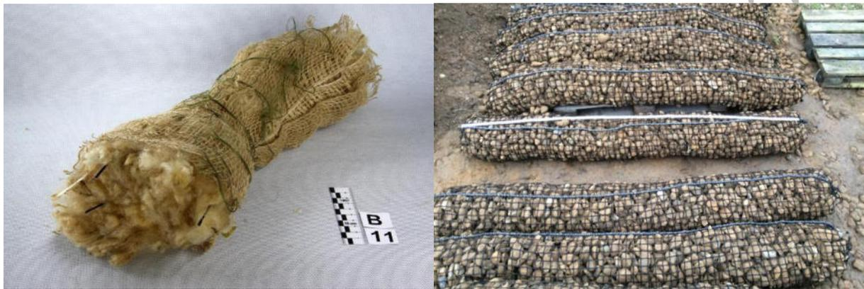
Bild 3.6 Faschine mit ungewaschener Schafwolle gefüllt, mit Jutenetz umhüllt, innenlaufende Führungsseile aus Naturgarn; Steinwalzen mit PP-Netz umhüllt (Foto: S. Wiese).
