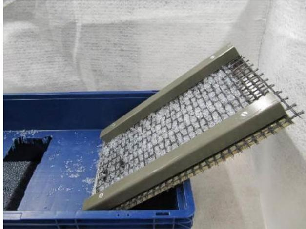
**Bild A10.3.2:** Kontrollmessprobe gefüllt mit Glaskugeln auf der geneigten Ebene (Foto: SKZ – Testing GmbH)
