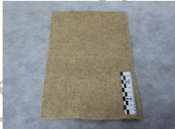
**D. Vliesstoff** aus Flachsfaser, mechanisch
