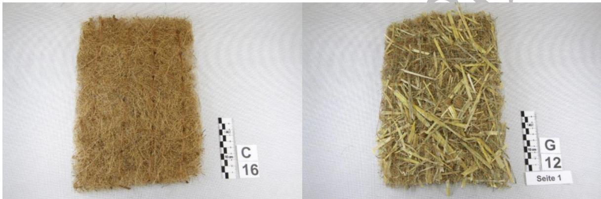
Bild 3.1 Erosionsschutzmatten. Links: Kokos mit PP-Trägernetz; rechts: Stroh-Kokos mit PP-Trägernetz
