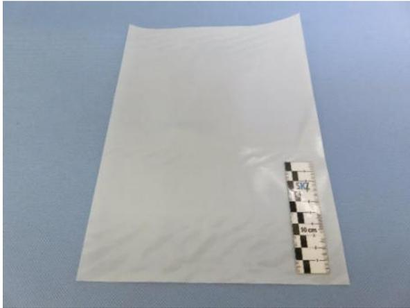
**Baufolie** aus Polyethylen (PE)
