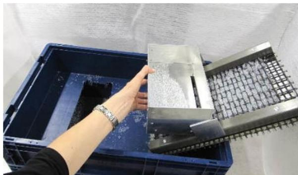
**Bild A10.3.3:** Befüllen der Kontrollmessprobe (Foto: SKZ – Testing GmbH)
