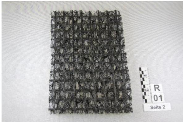
**A. Verbundstoff** aus einer PP-Geomatte und einem PVC beschichteten PET-Geogitter
