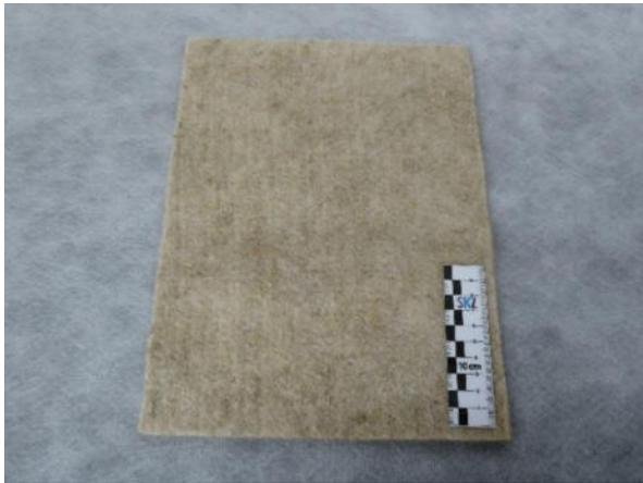
**C. Vliesstoff** aus Flachsfasern und PP-Fasern,
