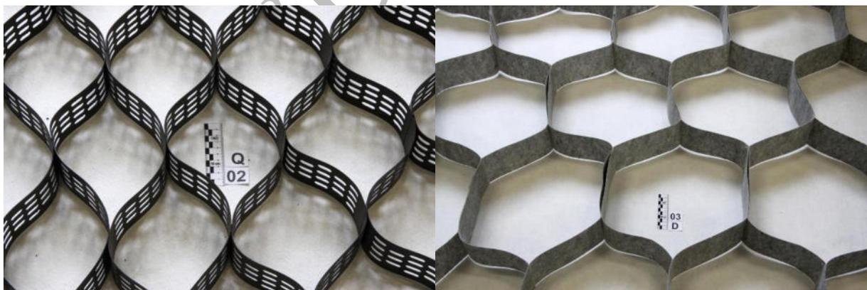
Bild 3.7 Geozellen. Links: PE-HD, dreidimensionale Wabenstruktur, gelocht, Höhe 75 mm, verschweißt; rechts: PET/PA, dreidimensionale Wabenstruktur aus Vliesstoffstreifen, vernäht
