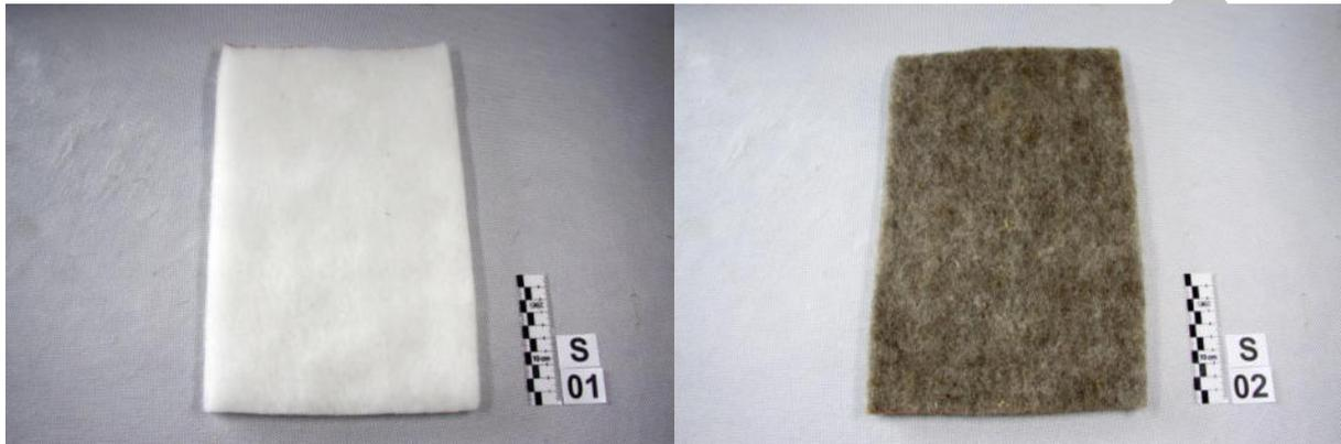
Bild 3.3 Vliesstoffe. Links: PLA mechanisch verfestigt, 500 g/m<sup>2</sup>; rechts: Schafwolle mechanisch verfestigt, 500 g/m<sup>2</sup>
