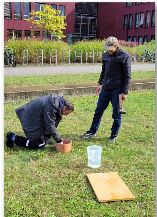
Infiltrationsmessung auf einer
