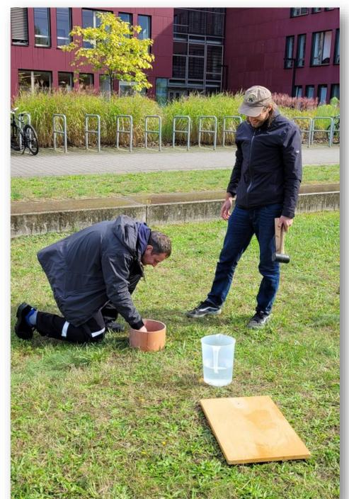
Infiltrationsmessung auf einer Versickerungsanlage
