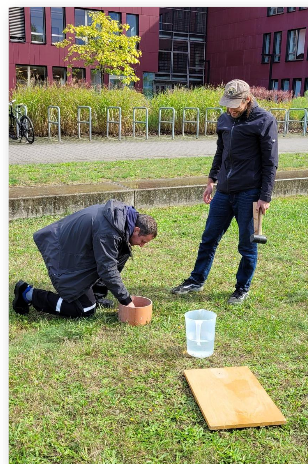
Infiltrationsmessung auf einer Versickerungsanlage
